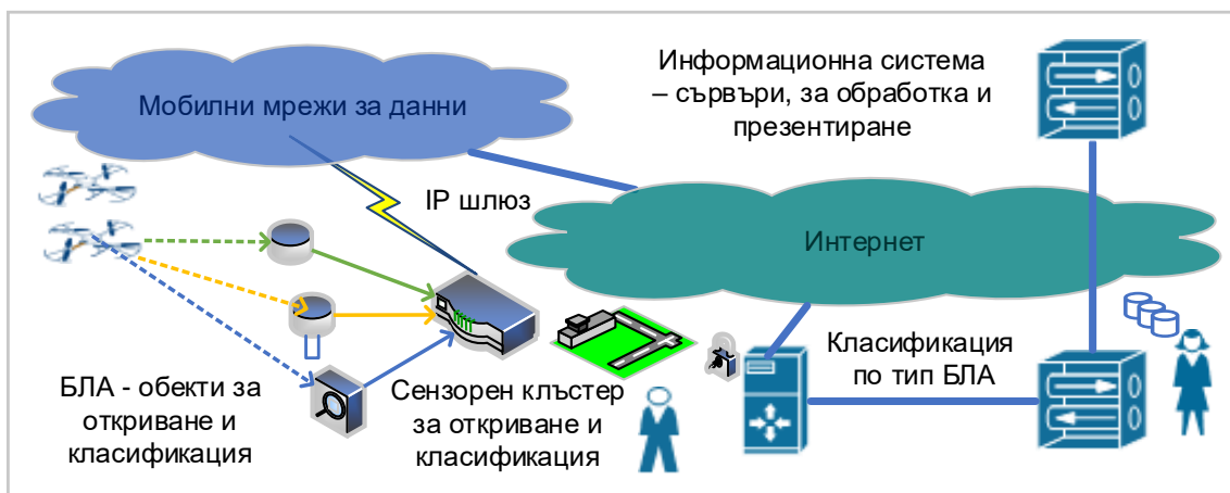
Фиг. 2. Функционална схема на мултисензорна система за откриване и класификация
